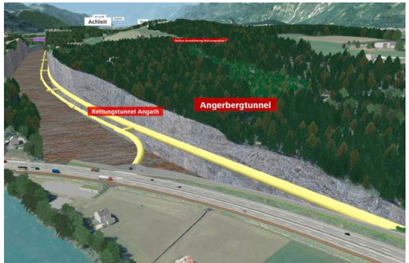
Angerbertunnel mit Rettungsstollen Angath
